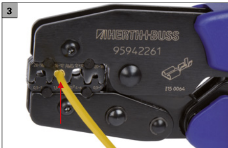
Korrekt abisolierten Leiter in den Kontakt einlegen.
