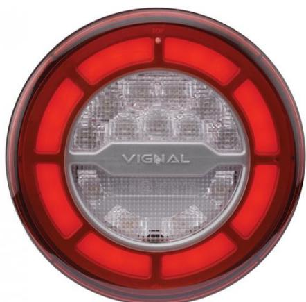
Compact et ultra fin, il possède des options simplifiant l'installation sur véhicule : une résistance intégrée pour le contrôle de défaillance de l'indicateur, des connecteurs additionnels pour raccorder les feux de position latéraux clignotants mais aussi un feu de position ou un éclairer de plaque...
