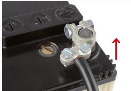
Die bislang am Minuspol angeschlossene Batteriepolklemme vom Pol abmontieren.
