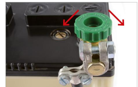
Lorsque l'on serre la vis moletée en direction « ON », on ferme le circuit. Pour interrompre le circuit, il suffit de tourner deux ou trois fois la vis moletée en direction « OFF ».
