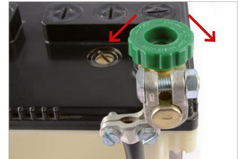
Durch Festdrehen der Rändelschraube in Richtung „ON“ wird der Stromkreis geschlossen. Um den Stromkreis zu unterbrechen genügen zwei bis drei Umdrehungen der Rändelschraube in Richtung „OFF“.
