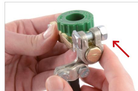
Sur le goujon de la partie intérieure de la cosse Quick Breaker, fixer la cosse négative que l'on a démontée précédemment.
