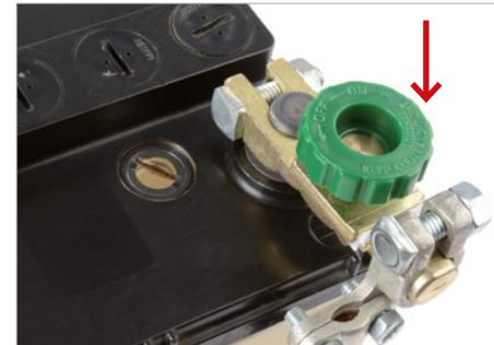
Die Quick Breaker-Klemme nun mit der soeben am Bolzen befestigten Minusklemme auf den Minuspol montieren.
